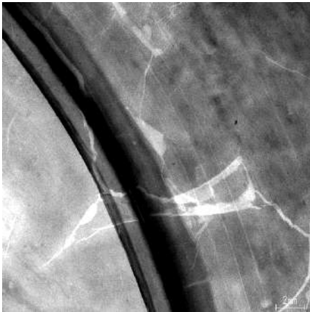
図 18-5 X 線透過画像（左図：見込みから銲縁，右図：テープ材の継ぎ目）
