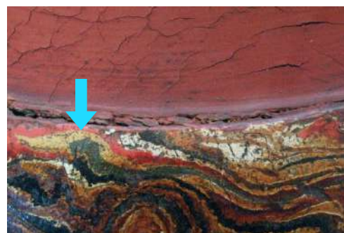
図 4-27 マクロ撮影（碁笥底周縁の塗膜摩耗箇所）
