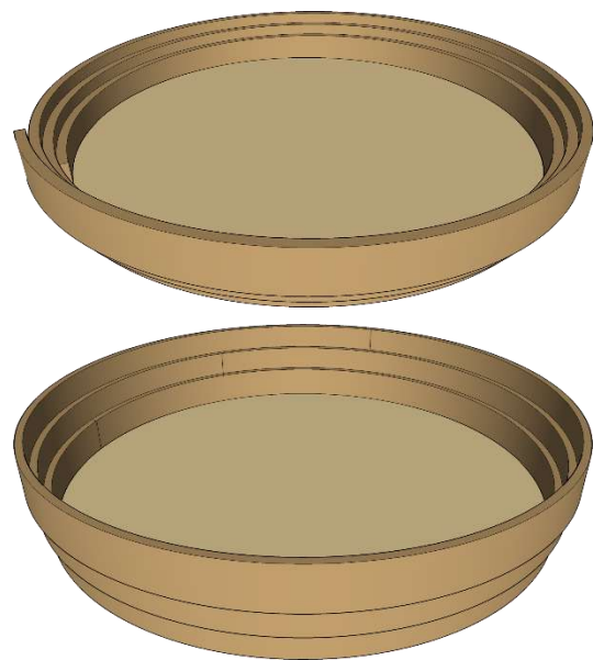
図 4-1 巻胎の構造（上図：巻き上げ法，下図：輪積み法）
