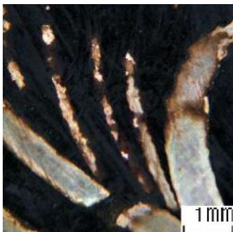
図 4-18 螺鈿部分の実体顕微鏡写真（二重蔓花唐草文，×20）
