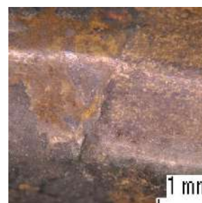
図 4-30 覆輪の継ぎ目（実体顕微鏡画像、×20）
