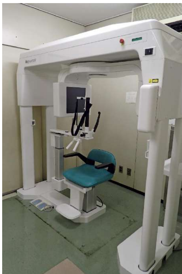
図 1-2 Alphard VEGA (歯科医療用に使用されている装置. 検出器と X 線照射装置が連動して回転する)
