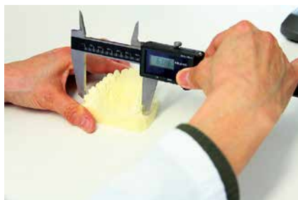
学生が実習で作った石膏でできた学生の歯型をノギスを使って、さまざまな角度や部分から測定し、記録。
