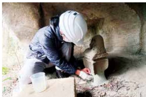
2019年2月。山中での塩類風化の測定作業。中世に作られた横穴で、測定しているのは明治の石像。水を絞ったガーゼで表面を拭き、水ですすぐ。これを繰り返して水の塩分濃度を測定
